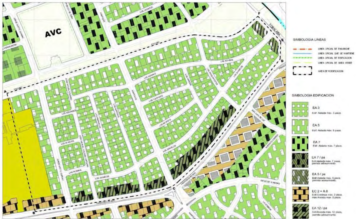
PLANO DE EDIFICACION PROPUESTO ESC. 1:2000.
